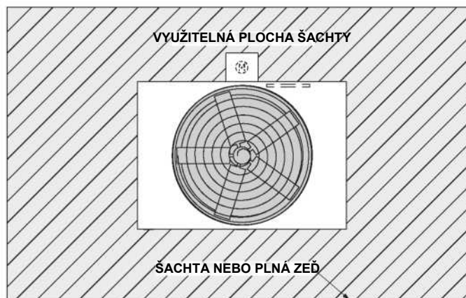
Obrázek 20 – Instalace v šachtě
